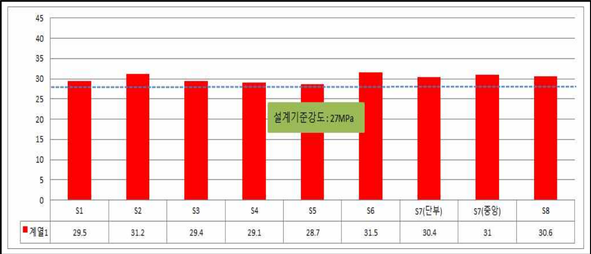
<그림 3.8> 콘크리트 강도조사 결과 (상부구조(안심방향))
