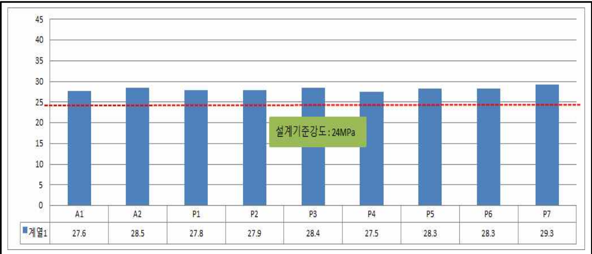
<그림 3.9> 콘크리트 강도조사 결과 (하부구조)
