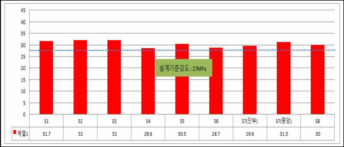
<그림 3.7> 콘크리트 강도조사 결과 (상부구조(범물방향))
